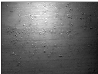
Rys. 4. System powłokowy AR na podłożu ocynkowanym - ślad po uderzeniu ciężarka spadającego z wysokości 42 cm (pow. x 10)
