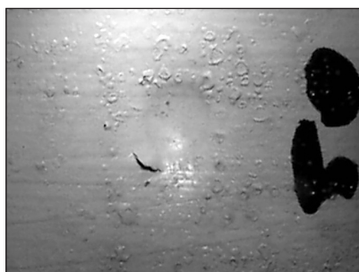
Rys. 5. Powłoka AW na podłożu stalowym - ślad po uderzeniu ciężarka spadającego z wysokości 50 cm (pow. x 10)
