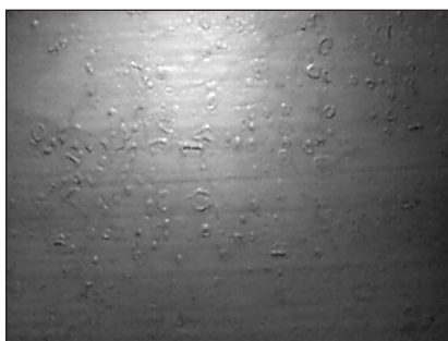
Rys. 3. Widok powierzchni powłoki AW na podłożu stalowym po ekspozycji w komorze solnej (pow. x 10)
