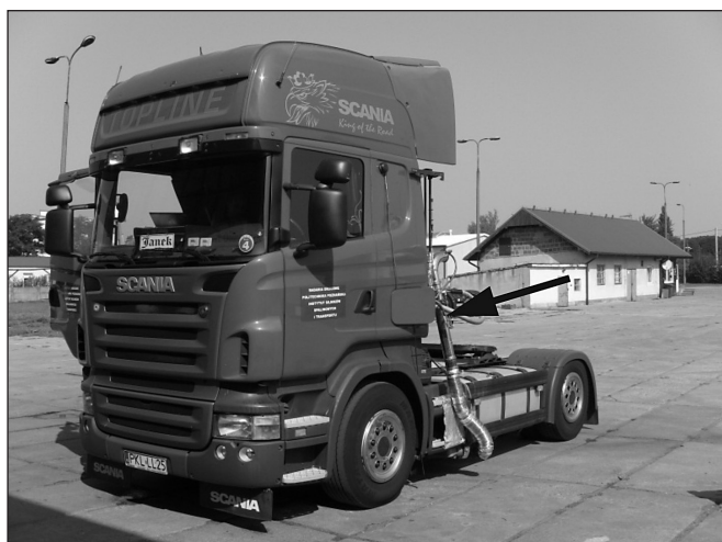
Rys. 5. Ciągnik siodłowy z zamontowanym przepływomierzem do pomiaru masowego natężenia przepływu spalin zaznaczony strzałką
