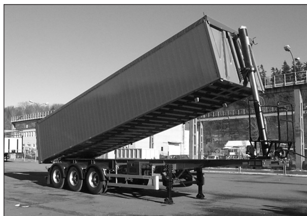
Rys. 3. Naczepa samowyładowcza z zamknięciem skrzyni wywrotczej typu drzwi [6]
