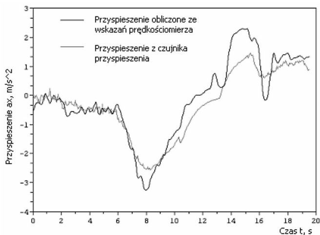
Rys. 8. Porównanie chwilowych wartości przyspieszenia uzyskanych z czujnika przyspieszenia oraz ze zróżniczkowanego sygnału prędkości liniowej pojazdu. Dane uzyskano z testu drogowego wykonanego z użyciem samochodu Fiat Punto II
