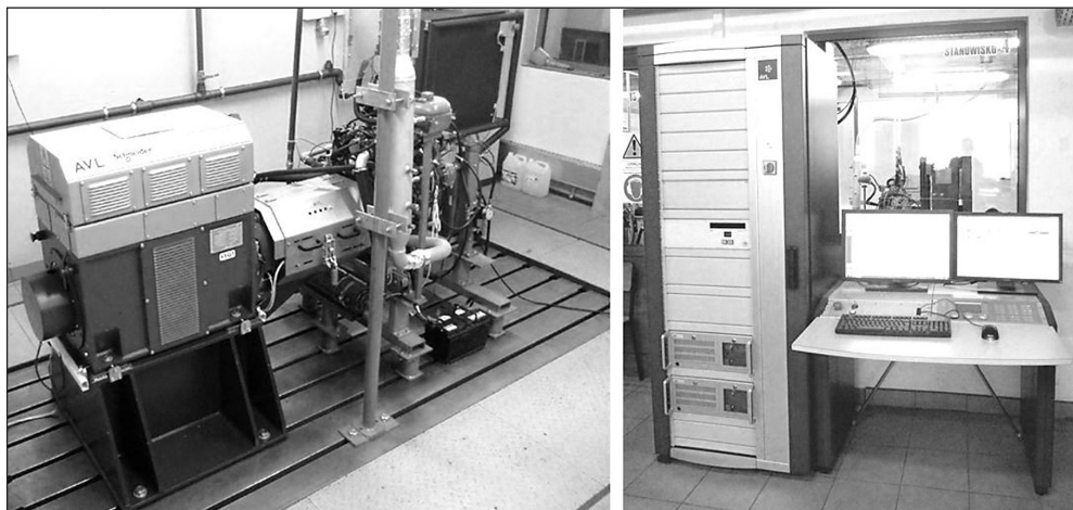
Rys. 1. Widok stanowiska do badań silników spalinowych wyposażonego w hamulec dynamiczny
