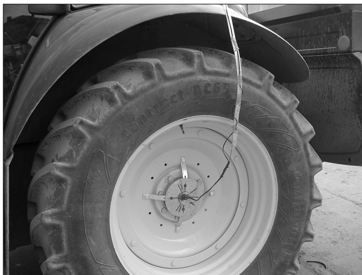
Rys. 10. Czujnik urządzenia Dynomet DK zamontowany na kole ciągnika kołowego
