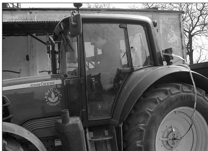
Rys. 8. Pomiary parametrów ciągnika rolniczego John Deere 6930 przy wykorzystaniu hamowni dynamicznej Dynomet
