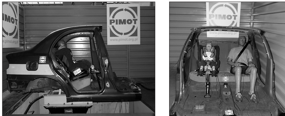
Rys. 3. Fotelik FX typu ISOFIX z manekinem DZIECKO (D) oraz manekin HYBRID II (H2) na stanowisku
