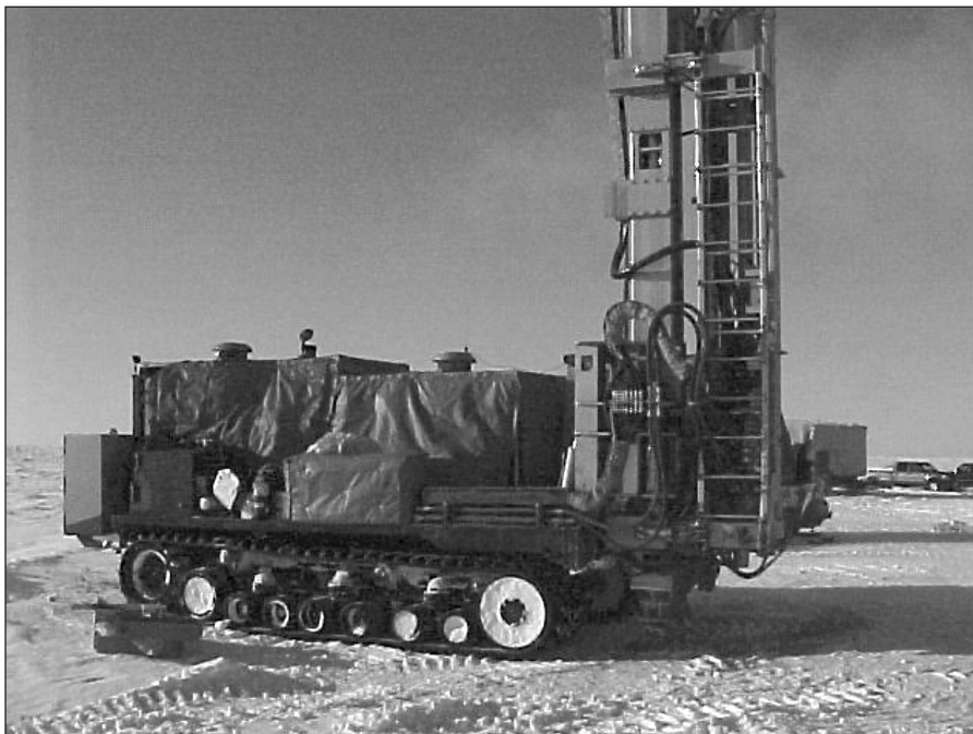
Rys. 10. Pojazd ze zmodyfikowanym układem jezdny w czasie testów w tundrze Kanadyjskiej
