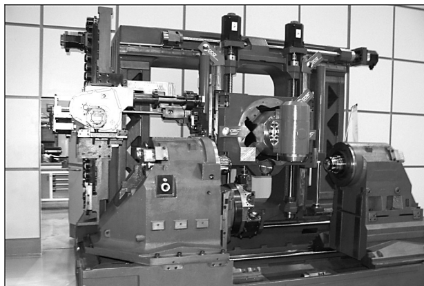
Rys. 4. Innowacyjne rozwiązanie konstrukcyjne obrabiarki z wieloma korpusami (opr. własne)
