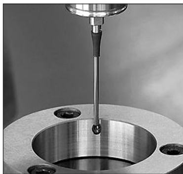
Rys. 14. Przykład kalibracji sondy pomiarowej przedmiotowej
