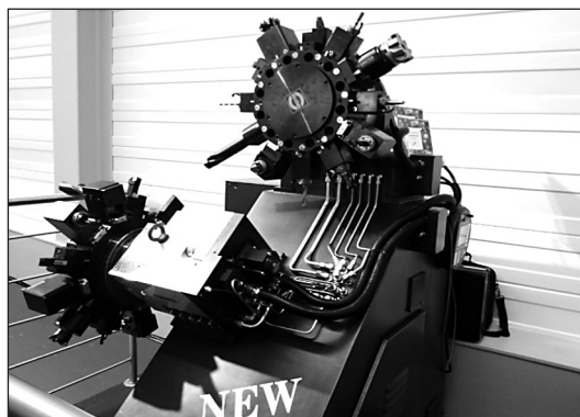
Rys. 10. Obrotowe głowice wielonarzędziowe
