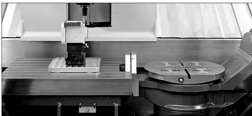
Rys. 12. Stół obrotowy (a) i obrotowo uchylny (b) obrabiarki CNC
