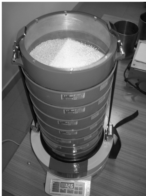
Rys. 3. Stanowisko badawcze do oceny składu granulometrycznego nawozów rolniczych i ogrodniczych za pomocą analizy sitowej
