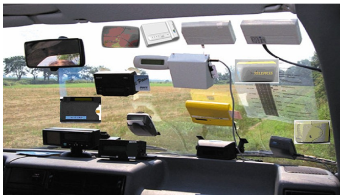
Rys. 3. Urządzenia pokładowe OBU aktualnie stosowane w pojeździe [4]
