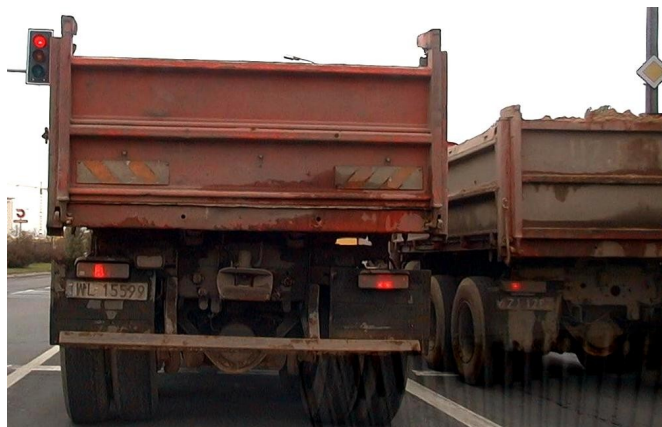
Rys. 8. Przykłady samochodów samowyładowczych tej samej marki i typu – z tylną belką przeciw najazdową oraz bez niej
