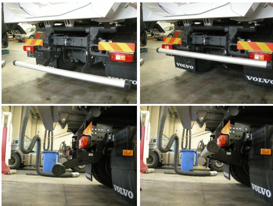
Rys. 10. Przykład zastosowania tylnej belki przeciwnajzdowej przestawianej na czas wypadku
