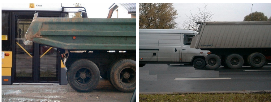
Rys. 9. Przykład symulacji skutków możliwego najechania autobusu lub samochodu dostawczego na wystającą nadmiernie skrzynię ładunkową pojazdu samowyładowczego
