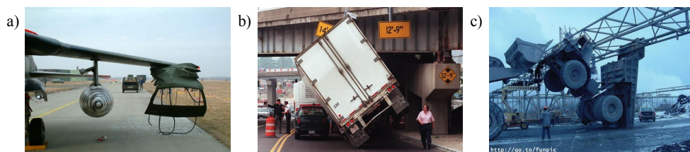
Rys. 1. Przykłady uszkodzeń w wyniku ruchu pojazdu o wysokości większej niż skrajnia. Wysokość i położenie przeszkody może zmieniać się w czasie a); kolizja z przeszkodą usytuowaną ukośnie do kierunku ruchu pojazdów stwarza dodatkowe zagrożenie dla innych uczestników ruchu b); przeszkoda ażurowa w postaci kratownicy c)
