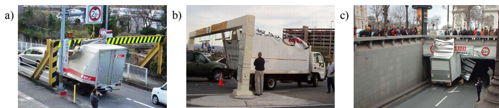
Rys. 2. Kolizja pojazdu z zabudową znacznie wyższą niż wysokość kabiny kierowcy. Oznakowanie skrajni występuje wyłącznie w miejscu jej zabudowy a); kolizja stwarzająca dodatkowe zagrożenie dla pojazdu jadącego z tyłu b); oznakowanie skrajni niewystarczające i nieczytelne c)
