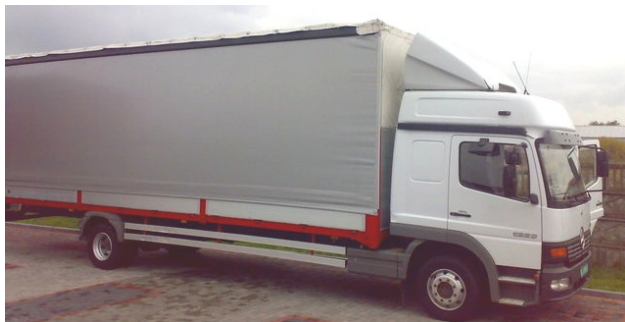
Rys. 8. Mercedes Atego 1233. Widoczna nisko położona górna krawędź przedniej szyby w stosunku do wysokości pojazdu
