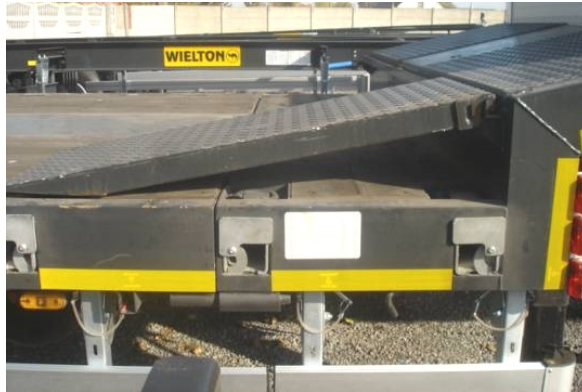
Rys. 11. Przenośne najazdy umożliwiające wjazd na balkon
