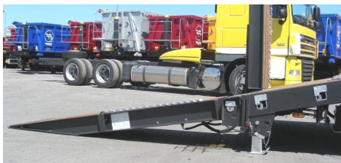
Rys. 10. Opuszczone najazdy tylne z wysuniętymi nogami podporowymi najazdów
