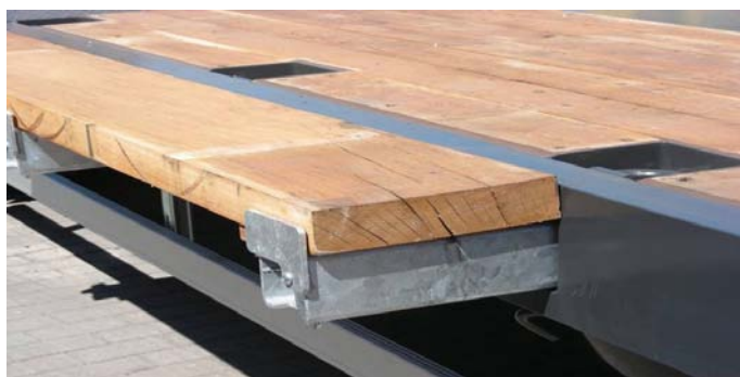
Rys. 9. Poszerzona platforma ładunkowa za pomocą deski położonej na wysuwającym wysięgniku
