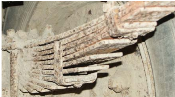
Rys. 1. Resor przyczepy zniszczony przez korozję
