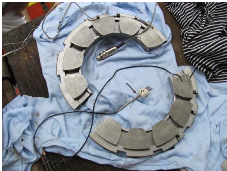
Rys. 9. Widok okładzin łożyska oporowego z uszkodzonym przewodem czujnika
