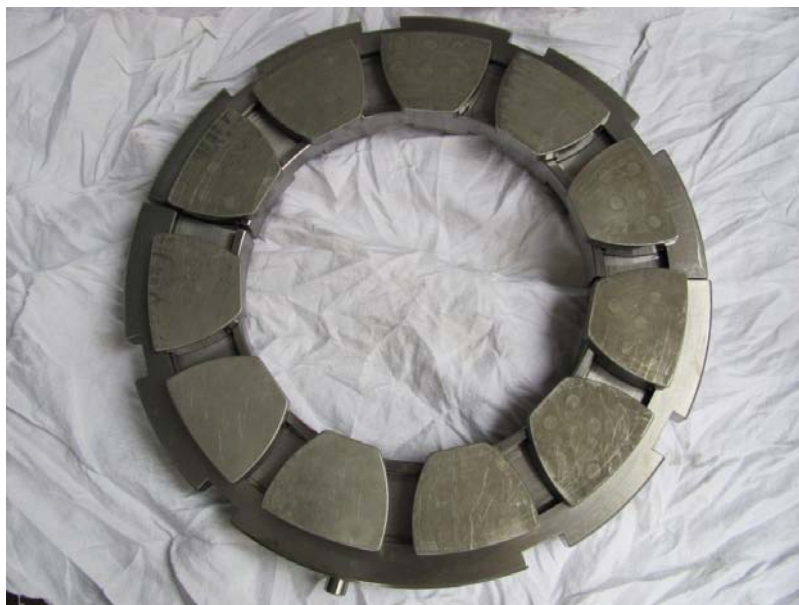
Rys. 8. Widok okładzin łożyska oporowego turbiny
