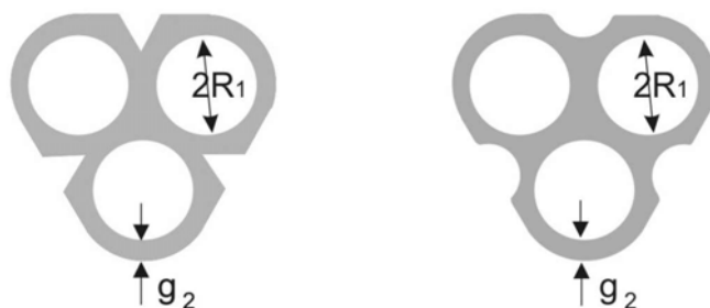
Rys. 6. Przykłady wytworów litych o kształcie złożonym z tunelami funkcjonalnymi z usunięciem nadmiarem materiału (model IVa oraz IVb)
