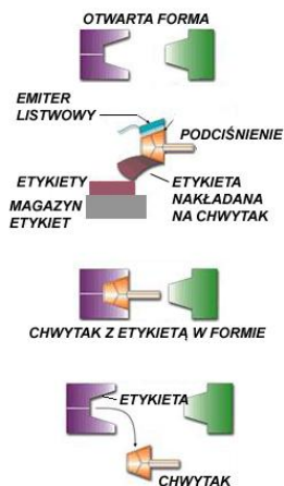
Rys. 2. Schemat wtryskiwania z etykietowaniem w formie [5]
