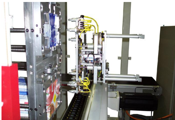
Rys. 3. Chwytak podciśnieniowy robota oraz forma wtryskowa z osadzonymi etykietami [7]
