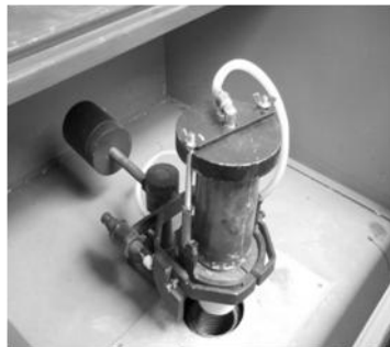
Rys. 4. a) piec indukcyjny F. IliGiacetti w Zakładzie Odlewnictwa Politechniki Poznańskiej b) zamocowana tuleja na tygiel pieca indukcyjnego
