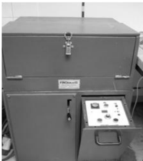
Rys. 4. a) piec indukcyjny F. IliGiacetti w Zakładzie Odlewnictwa Politechniki Poznańskiej b) zamocowana tuleja na tygiel pieca indukcyjnego
