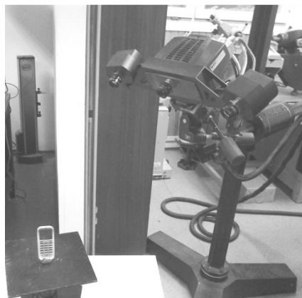
Rys. 6. Współrzędnościowy skaner optyczny Atos II [6]
