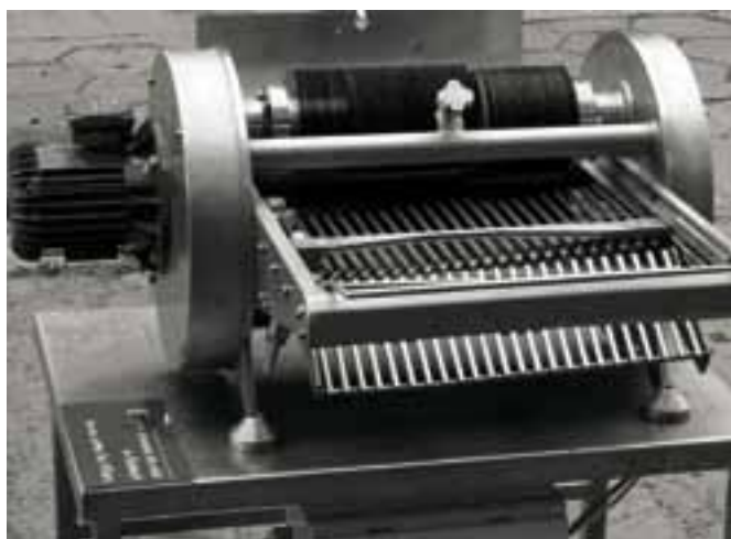
Rys. 6. Maszyna do przecinania ości w tuszkach karpia.
