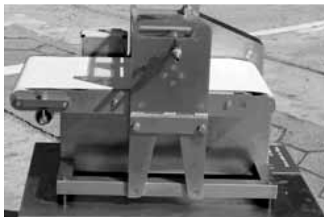
Rys. 8. Przenośnikowa przecinarka ości w filetach karpia i ryb karpiowatych.
