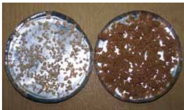
Rys. 2. Wycierka z ziemniaków: a) przed wysuszeniem, b) po wysuszeniu.
