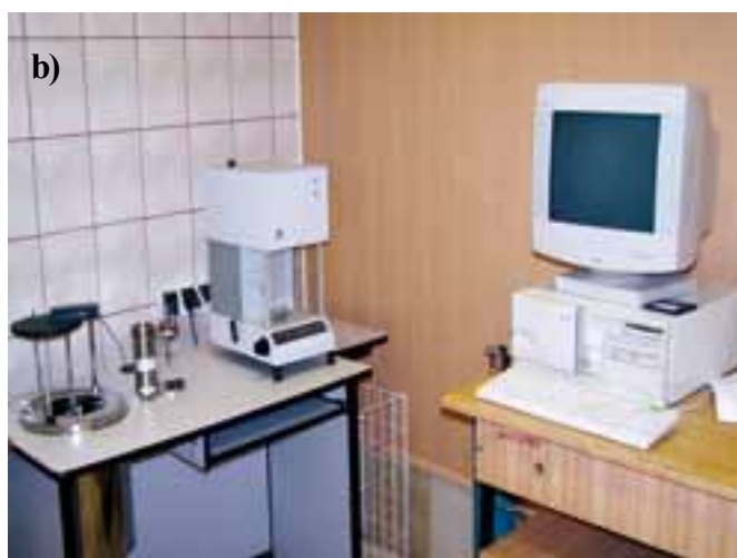
Rys. 1. Stanowisko KL 12Mn do wyznaczenia ciepła spalania i wartości opałowej [Instrukcja obsługi kalorymetru KL 12Mn]: a) schemat stanowiska: 1- bomba kalorymetryczna, 2-pokrywa kalorymetru, 3-czujnik temperatury, 4-uchwyt pokrywy z umieszczonym w nim napędem mieszadła, 5-mieszadło mechaniczne, 6-naczynie kalorymetryczne, 7-płaszcz kalorymetru, 7a-ścianka wewnętrzna, 7b-ścianka zewnętrzna, 7c-węzownica, 7d-mieszadło ręczne, 8-zespół sterujący kalorymetru, 9-komputer, 10-drukarka, 11- monitor, 12-stół kalorymetru, 13-listwa zasilająca, b) widok stanowiska.
