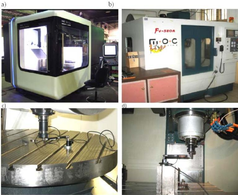
**Rys. 7.** Stanowisko badawcze: a) HSC 105 linear, b) FV580A, c) HSC z urządzeniem QC10, d) FV-580A z urządzeniem QC10
