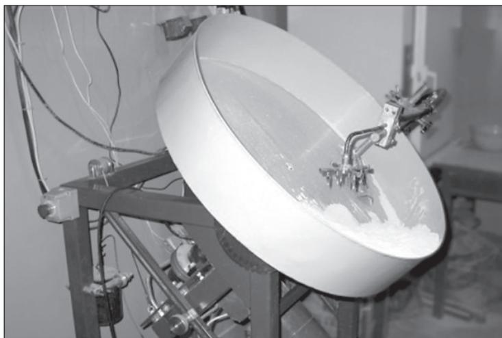
Rys. 2. Granulowanie na talerzu granulacyjnym
