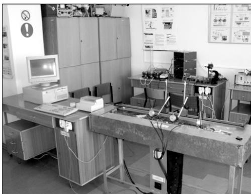
**Rys. 3.** Komputerowy system pomiarowy MRT-06-2: a) mikroprocesorowy rejestrator temperatury, b) widok ogólny stanowiska do monitorowania stanu cieplnego obiektów technicznych
