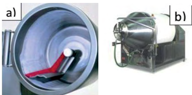
Rys. 1. Chłodzenie pośrednie masownic a) widok oszronionego wnętrza masownicy mieszadłowej b) widok izolowanego płaszczu masownicy bębnowej.
