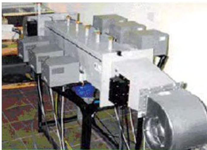
Rys. 5. Konstrukcja mikrofalowej suszarki komorowej (zaprojektowanej do suszenia ceramiki, ale mającej zastosowanie przy suszeniu ziół i owoców) [www.promis-tech.pl].
