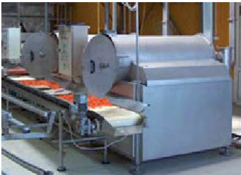
Rys. 7. Mikrofalowa suszarka bębnowo-próżniowa do suszenia warzyw, owoców i mięsa z tzw. efektem puffingu [www.promis-tech.pl].
