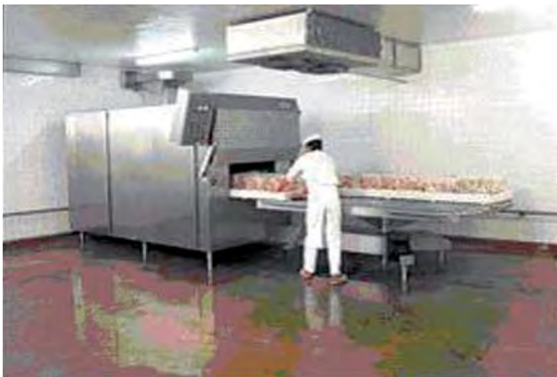
Rys. 2. Mikrofalowe urządzenie do rozmrażania mięsa francuskiej firmy SAIREM
