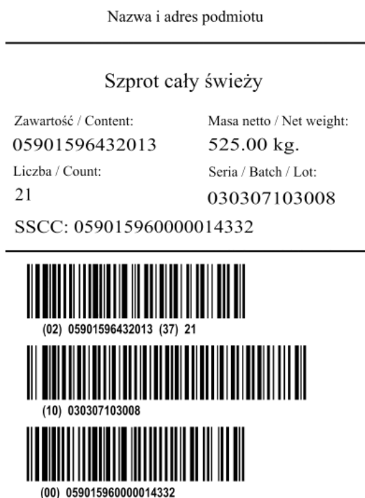
Rys. 1. Etykieta logistyczna z kodem kreskowym GS1-128.
