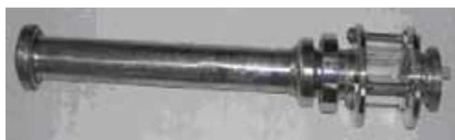
Rys. 2. Elementy kontrolne podlegające brudzeniu i ocenie skuteczności mycia.
