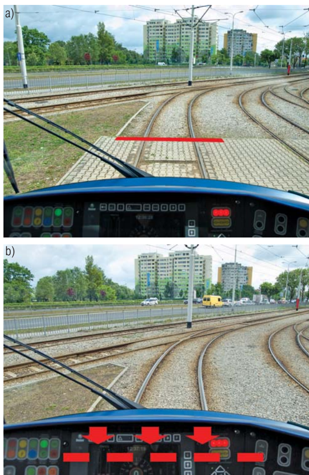
Fot. 8. Oznakowanie poziome w torze a – widoczność z dużej odległości, b – widoczność w miejscu zatrzymania Fot. W. Gąsior
