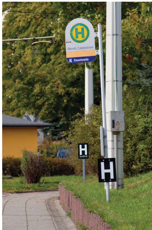
Fot. 14. Rozbudowane oznakowanie przystankowe na przykładzie Görlitz: znak przystankowy dla pasażerów (wysoki, zielono-żółte H) oraz dwa wskaźniki zatrzymania – główny (białe H na czarnym tle na pierwszym planie) i wariantowy dla długich pociągów (białe H z dopiskiem „2*KT4D” na drugim planie)
