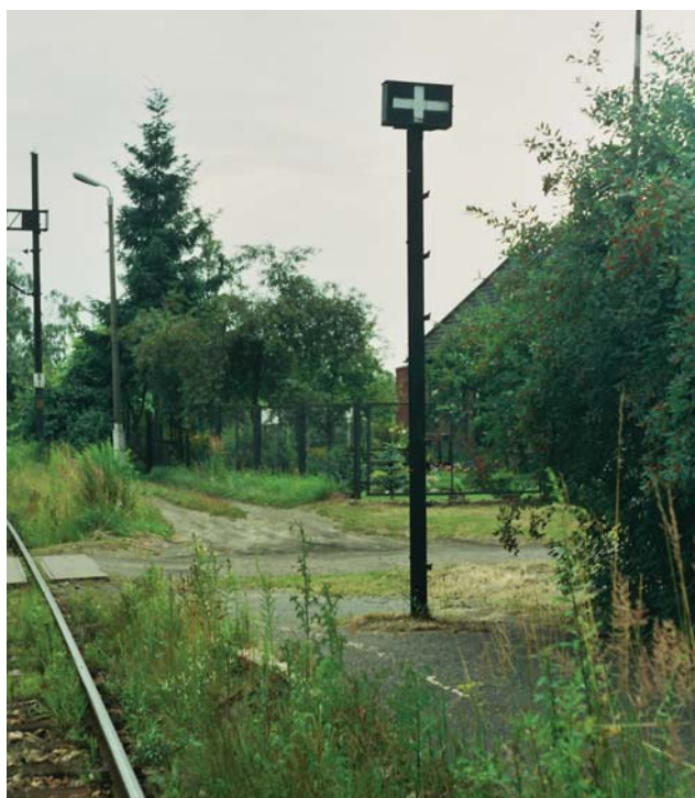
Fot. 1. Wskaźniki W4 obecnie a) tradycyjna latarnia na wysokim maszcie
