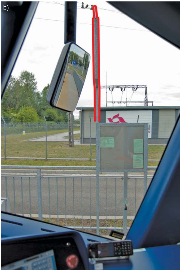
Fot. 11 Oznakowanie pionowe obok toru a – widoczność z dużej odległości, b – widoczność w miejscu zatrzymania
