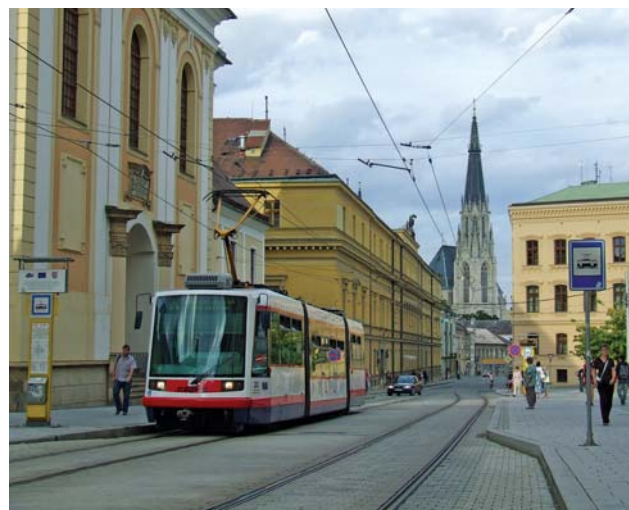
Fot. 15. Obecne znaki przystankowe, mieszczące się w kategorii znaków informacyjnych, niewystarczająco zwracają uwagę kierowców – są przez nich dostrzegane dopiero w momencie, gdy ich pojazd porusza się już w obrębie przystanku. Na zdjęciu rozwiązanie tego problemu w Olomuńcu – słupek przystankowy umieszczony na początku peronu (dla pasażerów i motorniczych) oraz znak drogowy, ustawiony na jego końcu (ostrzeżenie dla kierowców)
