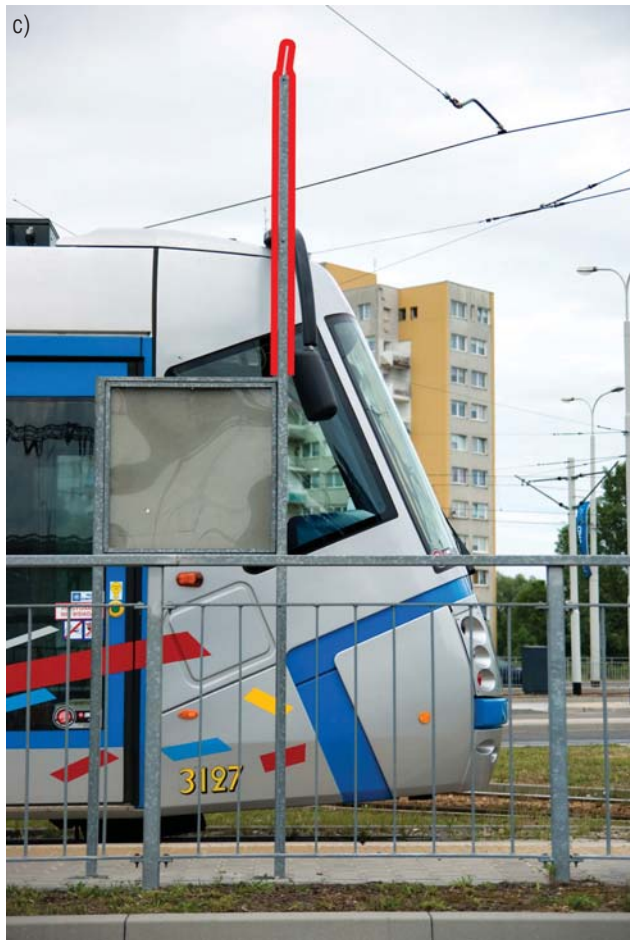
Fot. 11 Oznakowanie pionowe obok toru c – dokładność zatrzymania
