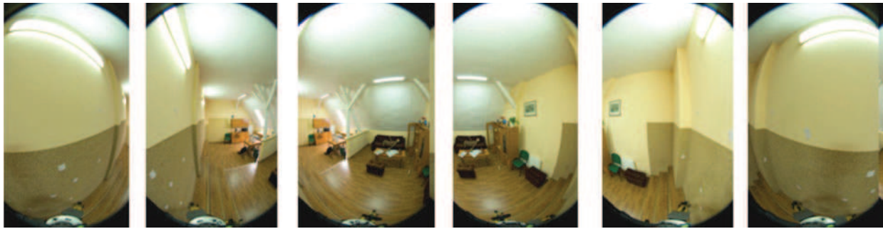
Rys. 3. Zdjęcie z mapowaną informacją o kolorze na chmurę punktów Fig. 3. A picture with colour information mapped on a point cloud
