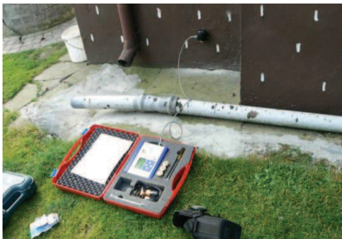
Rys. 2. Zestaw do pomiaru prędkości drgań Fig. 2. Vibration speed measurement set
