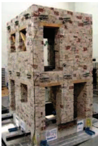
Fig. 13. Masonry model, reinforced using injections, on the shaking table Rys. 13. Model murowanej konstrukcji, wzmocnionej przy użyciu zastrzyków, na stole wstrząsowym
