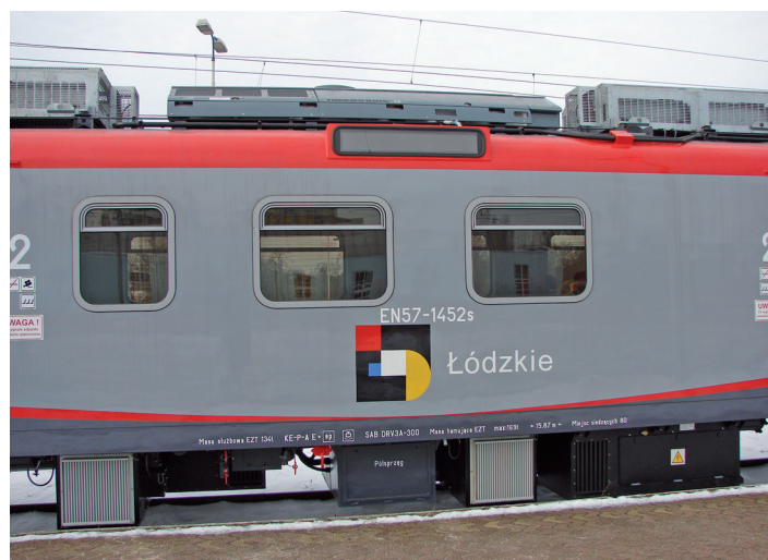
Fot. 7. Wagon silnikowy; na dachu widoczne rezystory hamowania i klimatyzator, a na spodzie wagonu – dławiki filtra sieciowego i falownik FT-500-300-UF-M
