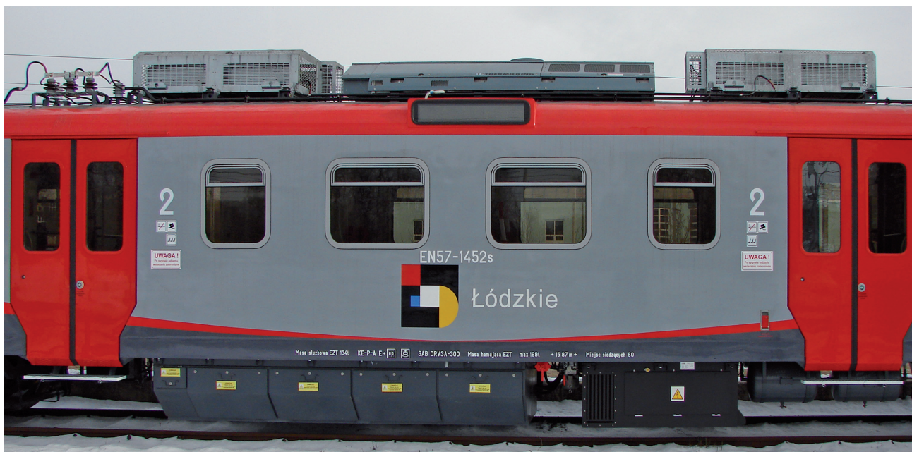
Niezbędne urządzenia zabudowano na dachu i pod podłogą jednostki
