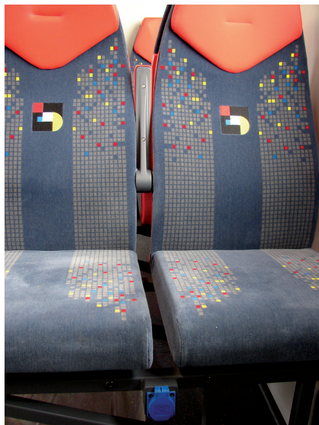
Każda para foteli jest wyposażona w gniazdko 230 V do podłączenia przenośnych urządzeń multimedialnych, np. laptopów
