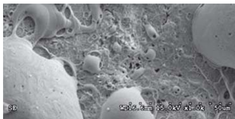
Ryc. 10. Fotografia SEM topografii podłoża miedzianego po naświetleniu kilkoma impulsami laserowymi. Gęstość energii – 5.3 J/cm 2 Fig. 10. SEM image of copper substrate topography after a multiple laser shoot. Fluence – 5.3 J/cm 2
