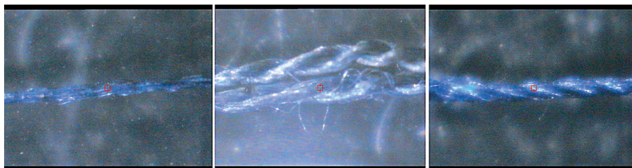
Ryc. 2. Zdjęcia mikroskopowe (50x) przedstawiające miejsce wykonania pomiaru dla próbek (od lewej): Białej Tary, Maitrei oraz „Milanówek” Fig. 2. Microscopic pictures (50x) of measurement area for samples (from left): White Tara, Maitreia and „Milanówek”
