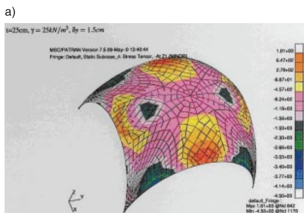
Ryc. 6. Numeryczny model konstrukcji przestrzennych żebier i uzebrowanej powłoki Fig. 6. Numerical models of a spatial rib construction and a ribbed shell (element belkowe = beam elements; węzły = knots; element powłokowe = shell elements)
