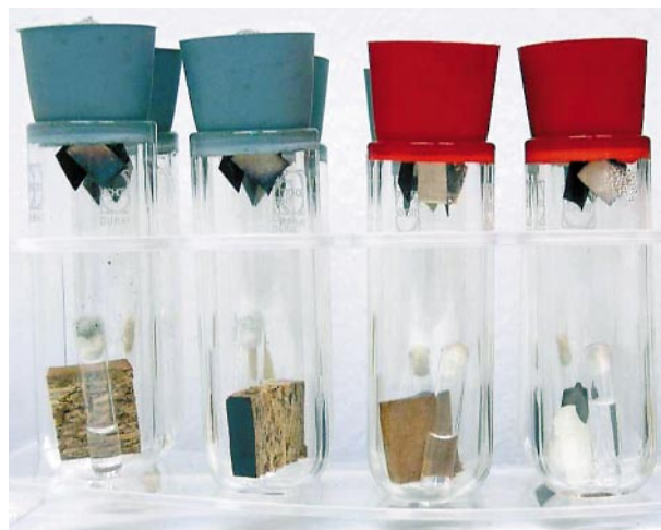
Ryc. 5. Zestaw do przeprowadzania testów Oddy'ego na materiałach stosowanych do budowy ram mikroklimatycznych w MNK Fig. 5. A set for conducting Oddy tests on materials used for building microclimatic frames in MNK
