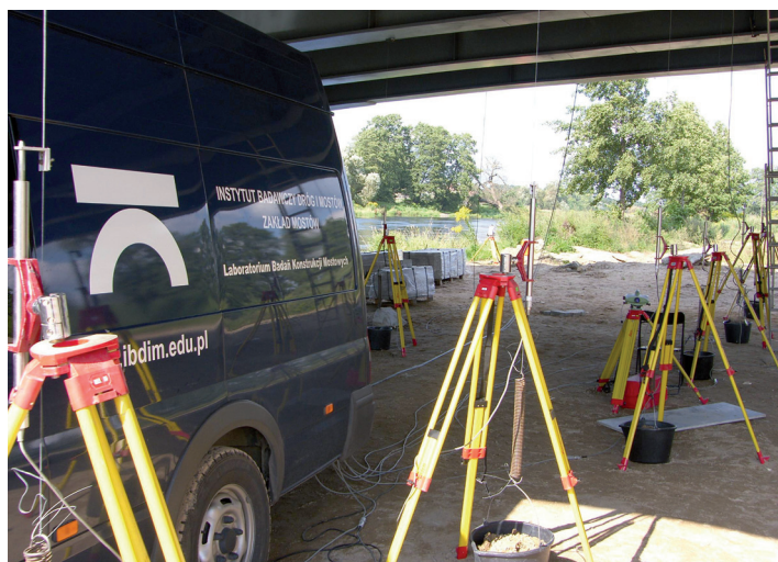
Fot. 3. Pomiar ugięć i przemieszczeń z zastosowaniem przetworników na sygnał elektryczny
