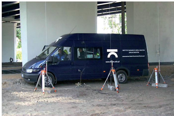
Fot. 1 Samochód badawczy IBDiM na stanowisku pomiarowym
