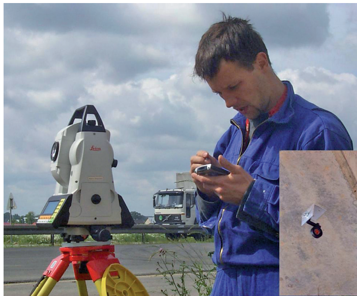
Fot. 6. Metoda pomiaru przemieszczeń z zastosowaniem automatycznego tachimetru elektronicznego
