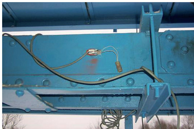
Fot. 4. Pomiar odkształceń i naprężeń z zastosowaniem elektrycznej tensometrii oporowej
