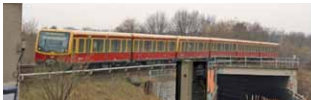
Fot. 1. Pociąg S-Bahn Berlin zestawiony z trzech ćwierćskładów serii 481 Fot. F.J. Restel
