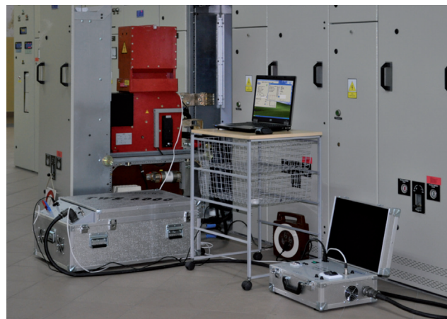
Rys. 3. Tester TWS-6000 na podstacji podczas testowania wyłącznika
