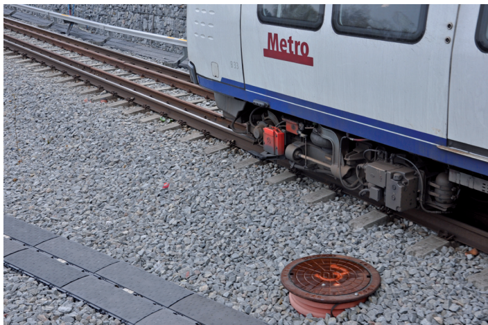
Ślizgacz do odbioru prądu z trzeciej szyny (30.04.2010 r.)
