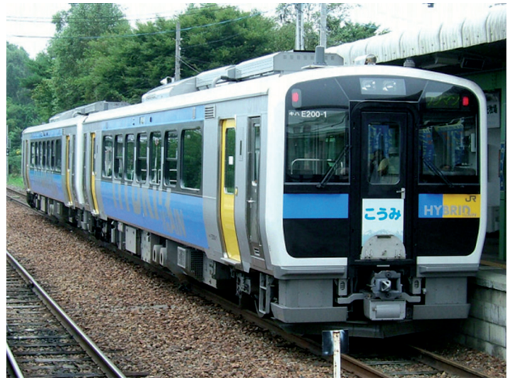
Fot. 2. Wagon silnikowy KiHa E200 kolei JR East z napędem hybrydowym
