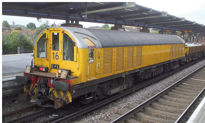
Fot. 1. Lokomotywa L16 o napędzie elektryczno-baterijnym, eksploatowana przez metro londyńskie
