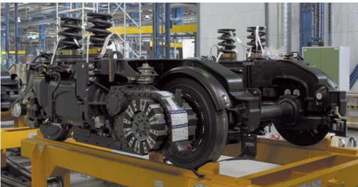
Ulokowana z boku wózka grupa napędowa z silnikiem i przekładnią renomowanej firmy Voith; u góry widoczne sprężyny drugiego stopnia odsprężynowania
