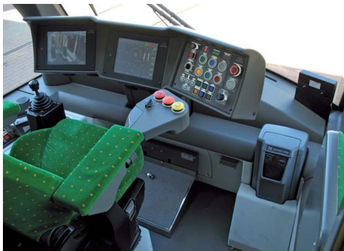
Wyposażenie kabiny motorniczego; zwracają uwagę dwa ekrany dotykowe na pulpicie oraz lodówka z prawej strony
