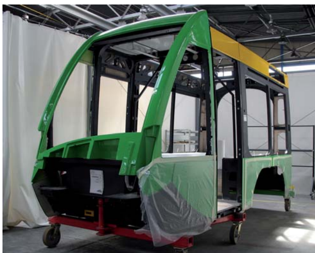
W hali montażowej przy ulicy Wieruszowskiej w Poznaniu nie ma lakierni, ponieważ poszczególne elementy poszycia dostarczane są już pomalowane
