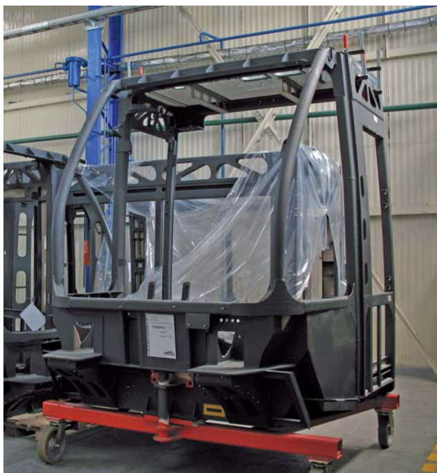
Konstrukcja członu czołowego zawiera klatkę bezpieczeństwa, chroniącą motorniczego
