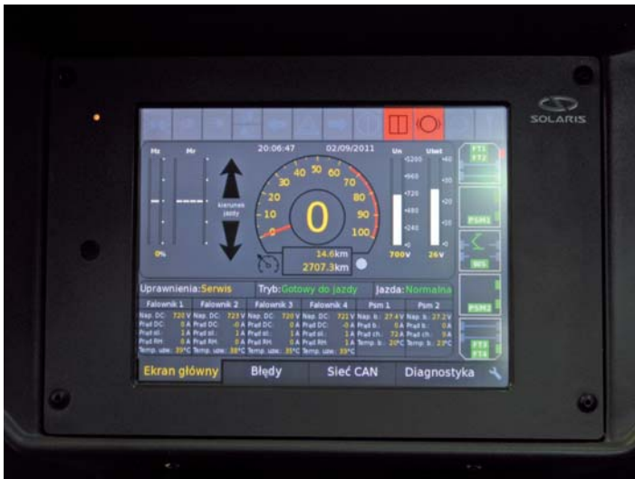
Ekran umieszczony w centralnej części pulpitu głównego pokazuje najważniejsze informacje eksploatacyjne
