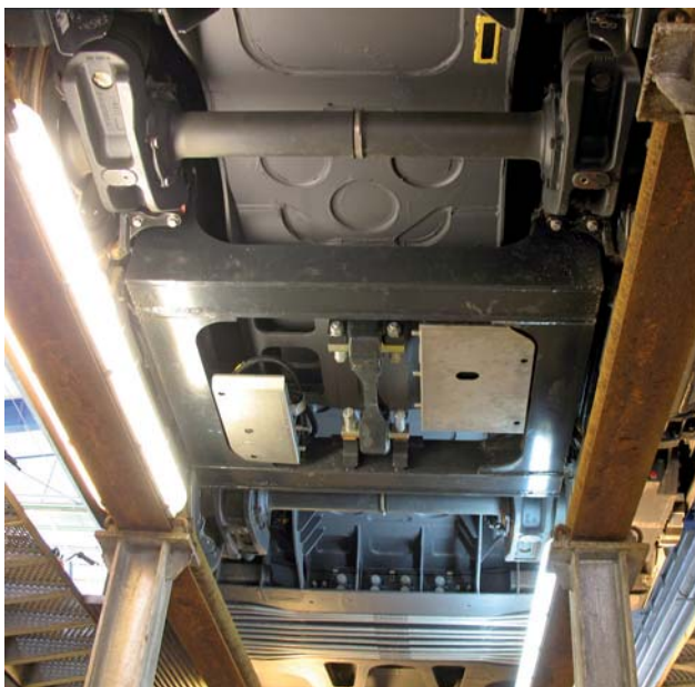
Wózek napędowy w widoku od spodu, wewnątrz ramy widoczne cięgiło trakcyjne
