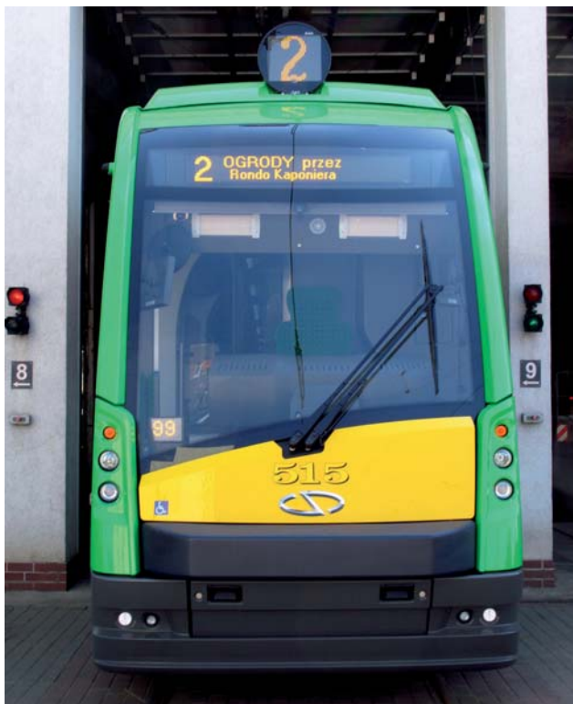
Tramwaje firmy Solaris wyróżnia, przeniesiona z autobusów, opadająca ku prawej stronie, dolna krawędź szyby czołowej
