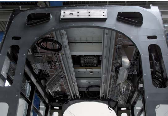
Zabudowa części sufitowej, widoczne listwy montażowe, a na pierwszym planie wręga od strony przegubu
