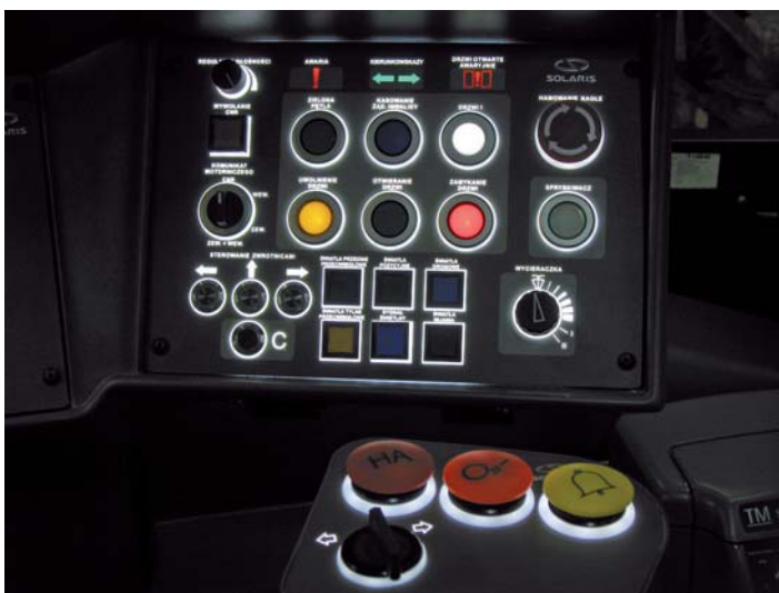
Na prawej części pulpitu głównego oraz na prawym podkolejniku znajdują się tradycyjne przyciski i przełączniki, sterujące między innymi: drzwiami, zwrotnicami, światłami zewnętrznymi, piasecznicami, dzwonkiem oraz hamowaniem awaryjnym
