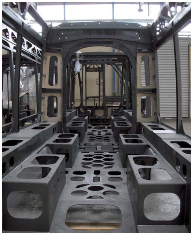
Ażurowa konstrukcja wpływa na obniżenie masy pojazdu
