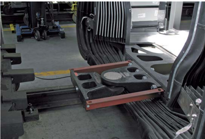
Dolne połączenie kulowe przegubu znajduje się bezpośrednio pod platformą przejściową
