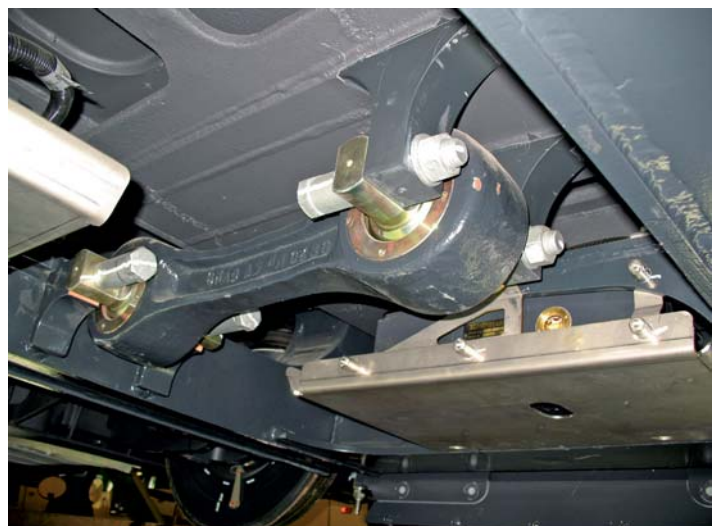
Umieszczone wewnątrz ramy wózka ciągiem trakcyjne stanowi jedyny element mocujący go do podwozia tramwaju, a po bokach ulokowano aparaturę hamulcową
