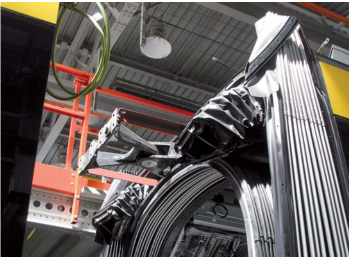
Górne połączenie kulowe przegubu umieszczone jest między zewnętrzną i wewnętrzną harmonią ochronną; po bokach widoczne kanały okablowania
