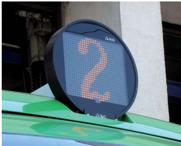
Zewnętrzne wyświetlacze numeru linii w kolistej obudowie, nawiązują do tradycyjnych tarcz dachowych, stosowanych w Poznaniu do niedawna
