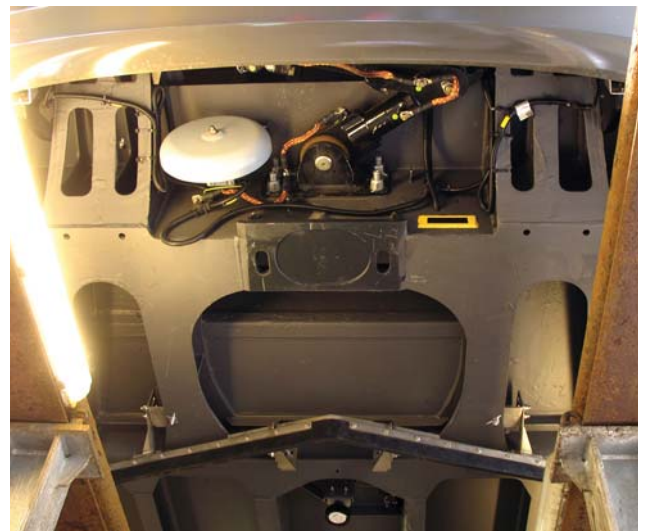
Tuż za czołową osłoną znajdują się: składany sprzęg z głowicą Alberta oraz dzwonek, a za nimi widoczny odgarniacz
