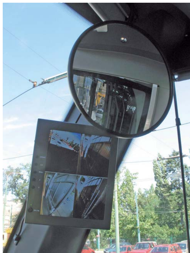
Na obu słupkach narożnych znajdują się wyświetlacze, zastępujące tradycyjne, zewnętrzne lusterka, a na prawym dodatkowo zamocowano lustro do obserwacji wnętrza za kabiną
