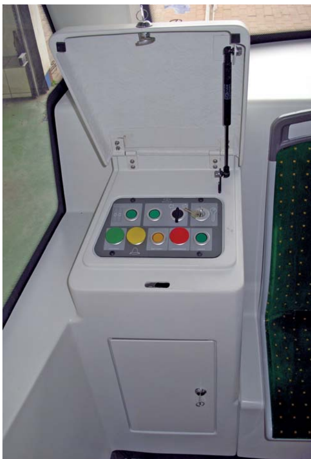
Tylny pulpit manewrowy ulokowano obok drzwi wejściowych
