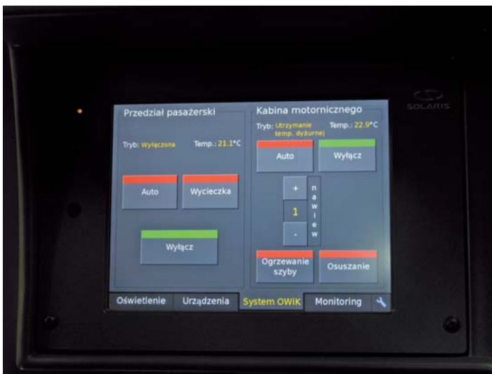
Lewa część pulpitu głównego zawiera ekran służący do wyboru ustawień różnych urządzeń lub pokazujący obraz z kamer monitoringu
