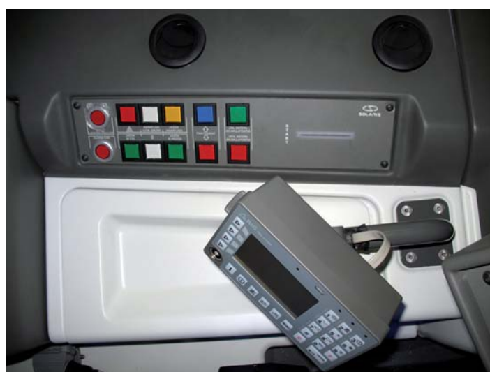
Boczny pulpit ze stacyjką w postaci czytnika kart, a przed nim sterownik systemów informacyjnych
