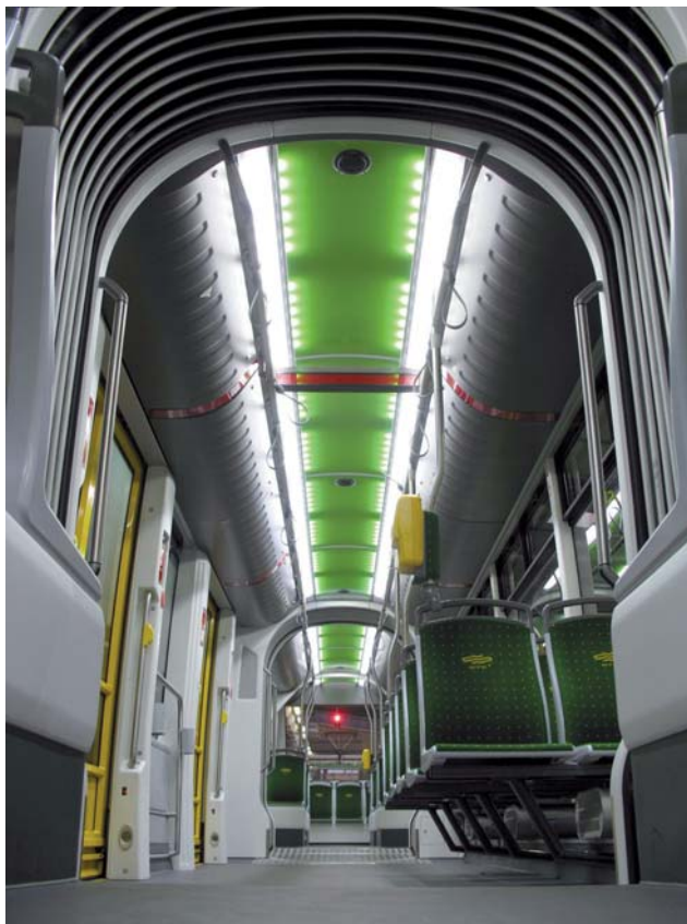
Efektowne oświetlenie kabiny pasażerskiej zrealizowano w całości za pomocą diod LED
