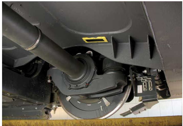
Mocowanie osi do ramy wózka zrealizowano za pośrednictwem sprężyny metalowo-gumowej, stanowiącej pierwszy stopień odsprężynowania
