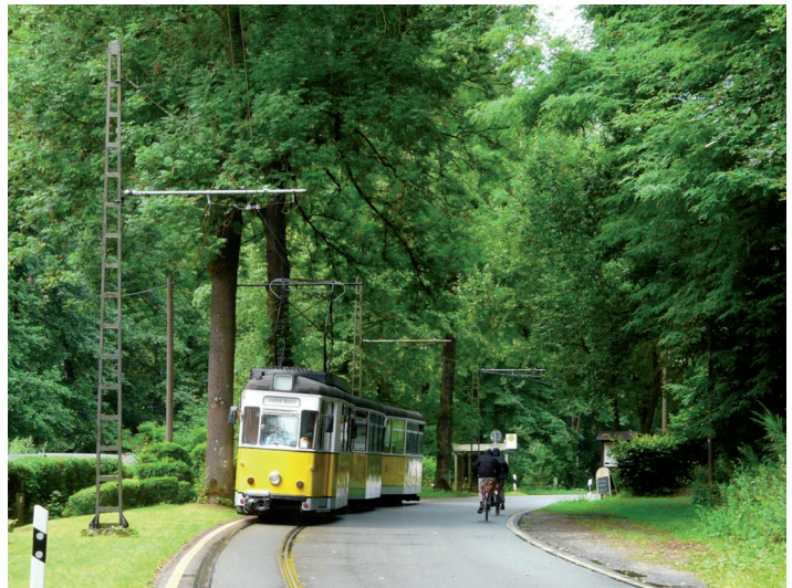
Fot. 1. Od początku istnienia linii torowisko tramwajowe ułożone jest asymetrycznie w ulicy Fot. M. Bartłomiejczyk
