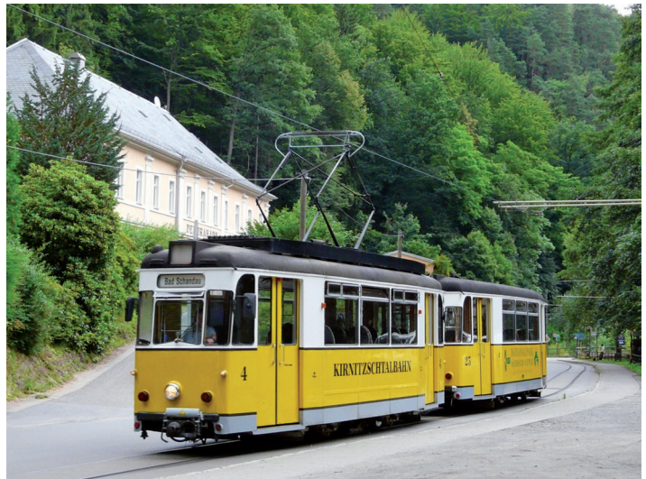
Fot. 2. Nieodłącznym elementem sieci są dwukierunkowe wagony Gotha Fot. M. Bartłomiejczyk
