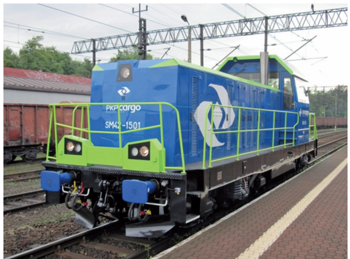
Fot. 1. Zmodernizowana lokomotywa SM42 w wersji 6Dg dla ISD Huta Częstochowa Sp. z o.o. i 6Dg/A dla PKP Cargo Fot. M. Górowski
