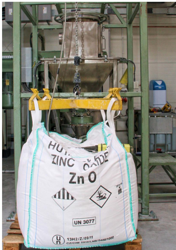
Rys. 2. Transport składnika masy warystorowej, w tle układ homogenizacji
