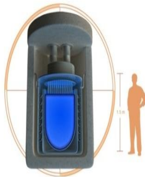
Rys. 1. Mały reaktor jądrowy typu Hyperion: moc cieplna 72 MW, moc elektryczna 27 MW, wysokość 2,6 m, średnica 1,6 m, czas budowy 1 rok, nakłady inwestycyjne 150 euro/1 kW mocy elektrycznej
