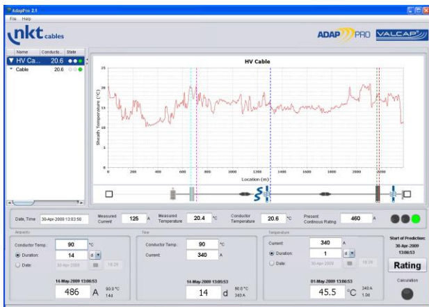
Rys. 3. Obliczona w modelu RTTF temperatura żyły roboczej na podstawie wprowadzonego profilu temperaturowego ekranu kabla, otrzymanego z światłowodu w systemie DTS
