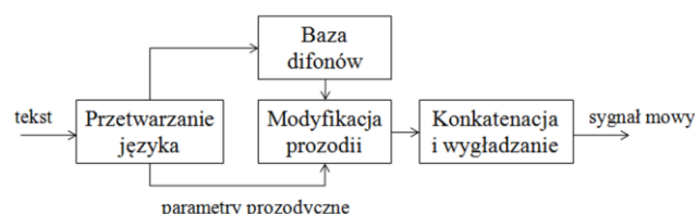
Rys. 1. Ogólny schemat blokowy systemu syntezy mowy
