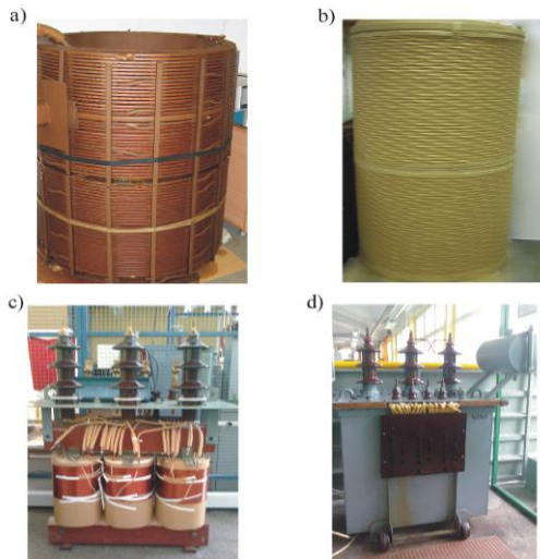
Rys. 1. Widok uzwojeń transformatorów doświadczalnych: a - uzwojenie górnego napięcia transformatora 25 MVA, b - uzwojenie górnego napięcia transformatora 25 MVA, c - uzwojenia transformatora 250 kVA, d - widok transformatora 20 kVA
